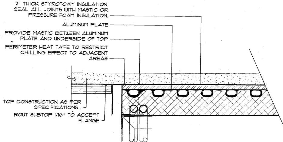
1. ROUT 1/16" DEEP RECESS ALONG ENTIRE PERIMETER TO ALLOW FOR FLANGE CLEARANCE
